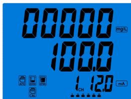
위 상태에서 CAL키를 5초 이상 누르면 ZERO, SPAN, CAL-MANUAL 아이콘이 뜨면서 수동교정모드가 된다. 이 때에 ENTER키를 누르면 설정 가능한 자릿수가 깜박거리고 SHIFT, UP키를 이용하여 0000ppm(mg/l)으로 맞춘다.
